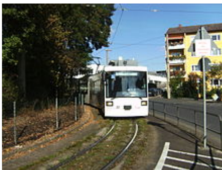
Ein Straßenbahnzug vom Typ GT-N bei der Einfahrt in die Wendeschleife Sanderau.
